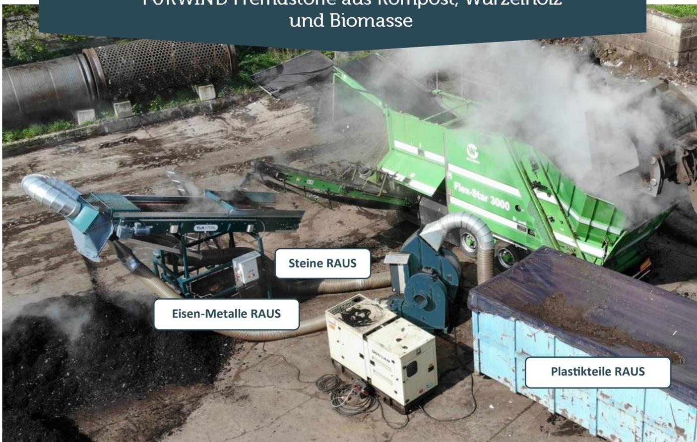
TUKSTON und TUKWIND, die beste Kombination für jede Siebmaschine:
