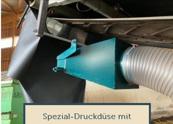
Spezial-Druckdüse mit verstellbarer Klappe
